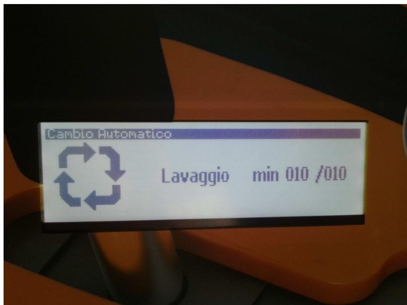
Quando sarà trascorso il tempo impostato la stazione emetterà alcuni BEEP e inizierà automaticamente la FASE 3 "Sostituzione olio convertitore". Sul display apparirà la quantità di olio da sostituire
