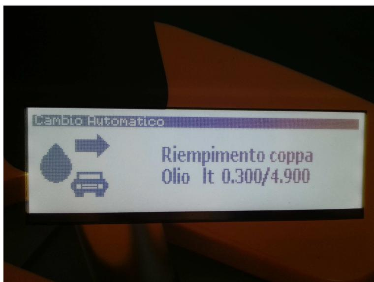
Una volta terminata l'immissione dell'olio nuovo in coppa la stazione emetterà dei BEEP e sul display apparirà la quantità necessaria per la sostituzione dell'olio presente nel convertitore (FASE 5)
